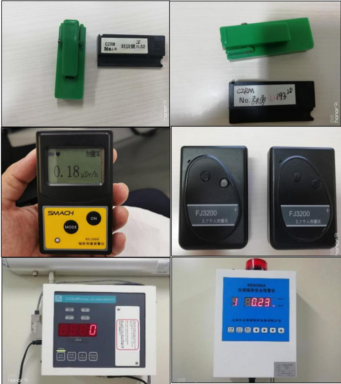
图 3-5 个人剂量计、个人剂量报警器、X—γ 剂量率仪和固定式 X—γ 剂量率仪照片
