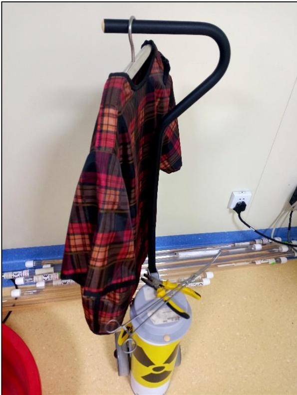
图 3-2 铅防护用品照片、后装机卡源应急设施
